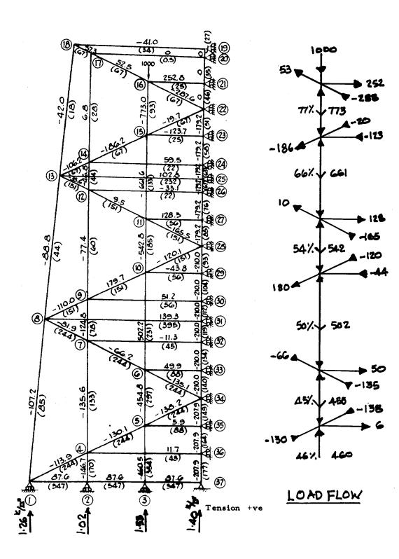
Fig. 6. Truss Module Load Flow
