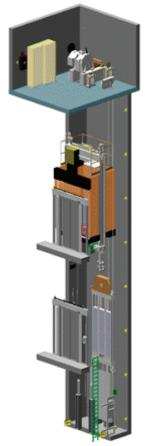
Figure 1. Typical elevator assembly (Schindler Internal) 图1. 典型电梯装配示意图 (迅达内部)
