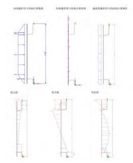
Figure 8. Typical Façade Analysis. (Werner Sobek) 图8. 标准幕墙分析图 (Werner Sobek)
