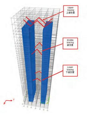
Figure 6. SSE Tower Structure. (Werner Sobek) 图6. 上交所结构图 (Werner Sobek)
