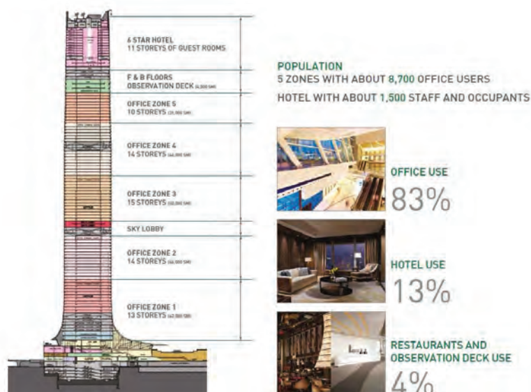
Figure 3. Space utilization (Source: Sun Hung Kai Properties Limited) 图3. 空间利用 (来源: 新鸿基地产)
