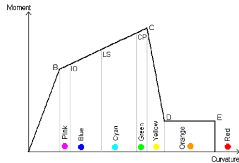
Fig. 12: Moment Rotation Hinge Definitions
