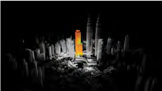
Figure 6. Point cloud image of the exterior frame (Source: Daewoo E&C) 图6. 周边框架点云图 (出自: 韩国大宇工程建设公司)
