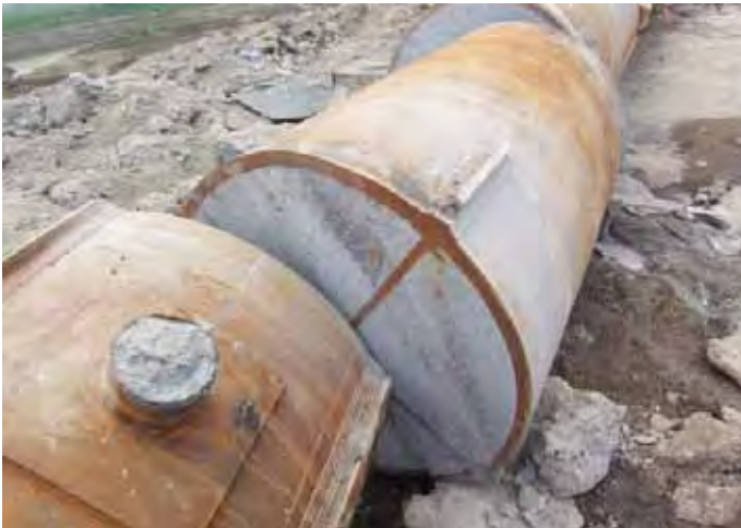
Figure 3. Section photo of test column (source: Yang Yaohui Gao Junfeng & Wang Jing) 图3. 试验柱断面照片 (出自: 杨耀辉)
