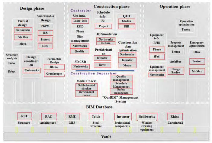
Figure 5.5. BIM technical framework (2013 version) (Source: Shanghai Tower Construction & Development Co., Ltd) 图5.5. BIM技术框架 (2013版) (来源: 上海中心大厦建设发展有限公司)
