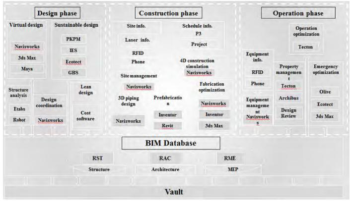
Figure 5.4. BIM technical framework (2010 version) (Source: Shanghai Tower Construction & Development Co., Ltd) 图 5.4. BIM技术框架 (2010版) (来源:上海中心大厦建设发展有限公司)
