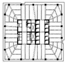
较低。优化方案取消了内排柱,采用密肋 梁楼盖体系,把竖向荷载传递到外围框架 柱上,有效地平衡了水平荷载在框架柱产 生的拉力,如图3.49所示。本次优化共节 约混凝土用量约3700方,节约钢筋约300 吨,节约材料成本约260万元,另外增加了 使用面积约560平米。
