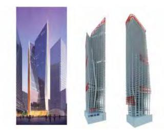
Figure 1. Overall rendering and structural system 图1. 全景渲染图和结构体系
