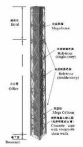
Figure 3.3D Illustration of Structural System 图3. 结构体系三维示意图
