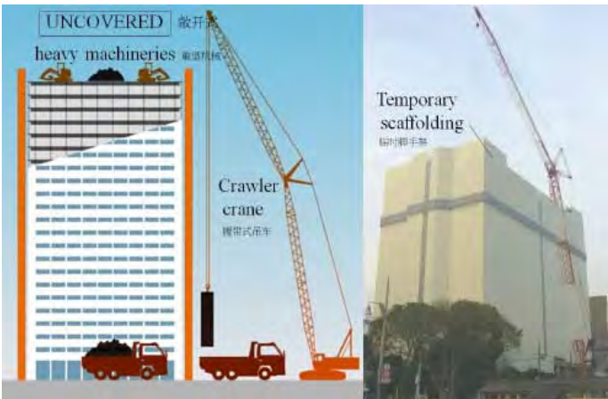
Figure 1. Traditional demolition method (source:TAISEI Corp.) 图1. 传统拆除方法（出自：大成建设）
