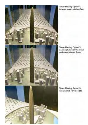
Figure 3. Tower Massing Options (Source: RWDI) 图3. 不同的塔楼(建筑)体量方案(来源: RWDI)
