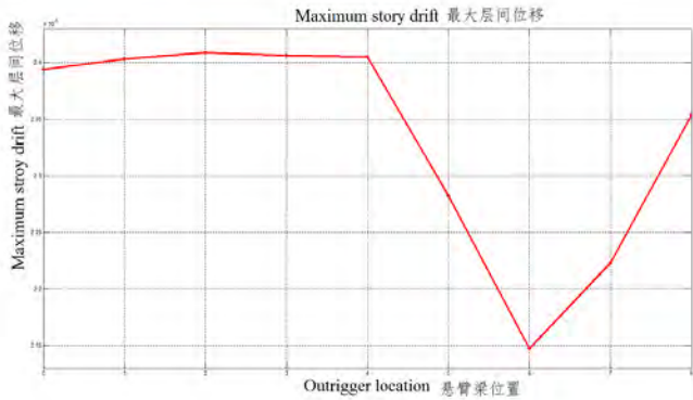
Figure 3.38. Maximum story drift (Source: Moukui Xu) 图3.38. 设置单道伸臂桁架时结构的最大层间位移角 (来源: 许谋奎)
